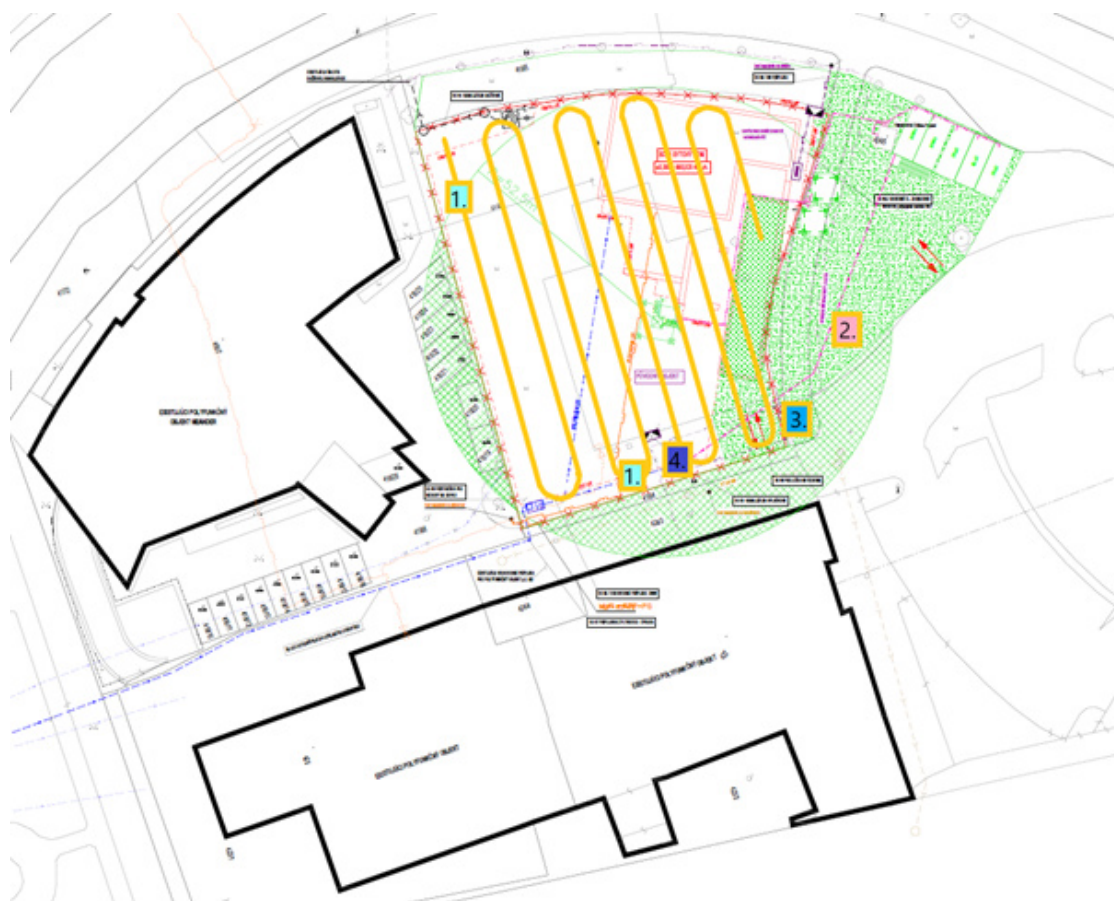
Obr. 130: Znázornenie pojazdu rýpadla pri výkopových prácach a ostatných mechanizmov
