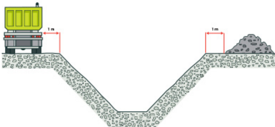
Obr. 140: Vyťažený materiál a náklad v blízkosti výkopu [13]
