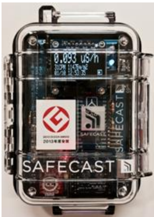
Obrázek 10 Detektor záření SAFECAST Zdroj: www.suro.cz
