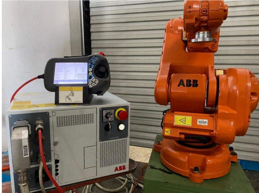
Obrázek 18 Průmyslový robot ABB, s kontrolérem a Teachpendantem
