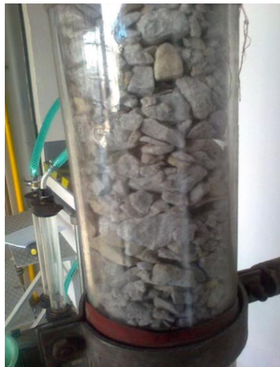
Obrázek 13: Sypaná vrstva vápence
