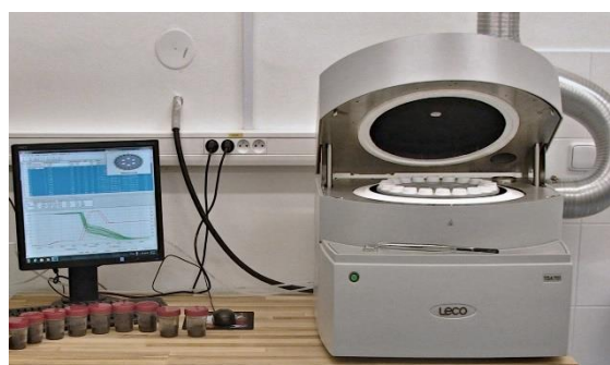
Obrázek 17: Analyzátor LECO TGA 701, CHN + S 628
