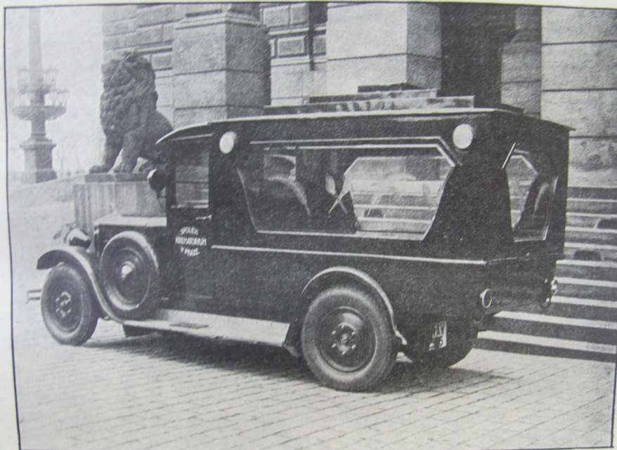
Pohřební auto spolku „Krematorium“ pro dopravu zesnulých členů. Karoserie podle návrhu Arch. Vlast. Hofmana, chassis Praga-mignon, šestiválcové. v Brně, p. Hnátka, přís. zemského výboru na Křenové, p. Josef Jeřábek, učitel v Husovicích, Král. Polí a Maloměřích. Výbor pečoval také o rozšíření návštěvních skříněk (podle vzoru jilemnického), kterými by veřejnost byla u-
