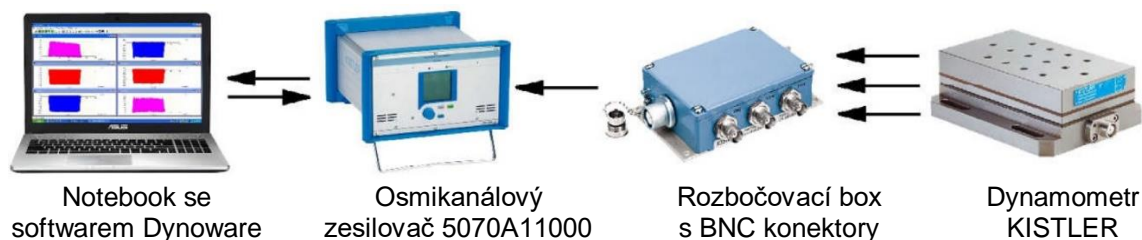
Obr. 4.10 Měřicí aparatura pro měření řezných sil [37].
