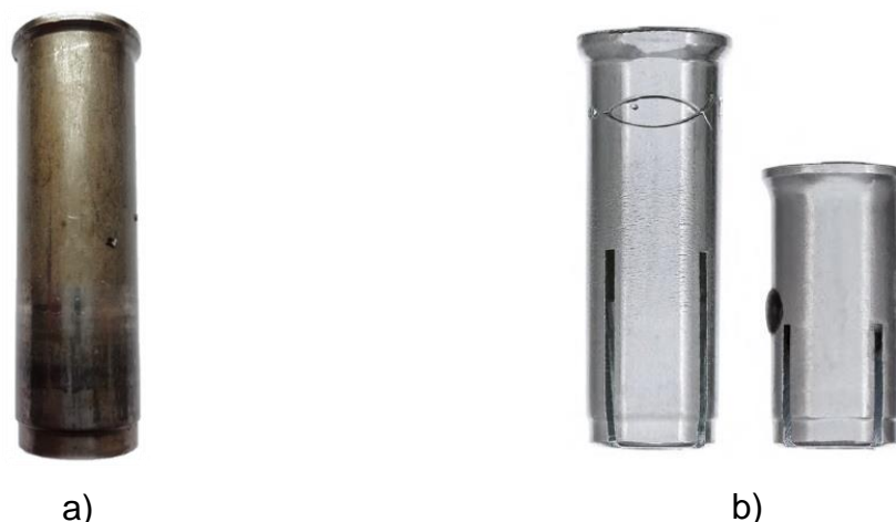
Obr. 3.1 a) výchozí polotovár, b) konečný produkt s již vyhotovenou drážkou [3].
