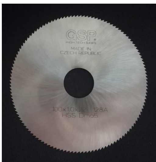
Obr. 4.4 Kotouče 100×1.0×22 128A, které se při obrábění zářezných kotev neosvědčily.
