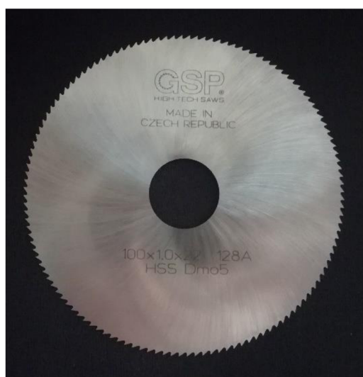
Obr. 4.4 Kotouče 100×1.0×22 128A, které se při obrábění zarážecích kotev neosvědčily.
