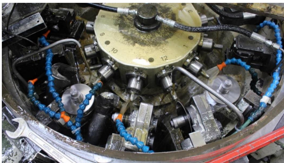
Obr. 3.3 Víceúčelový automat používaný k frézování drážek do obrobků [33].
