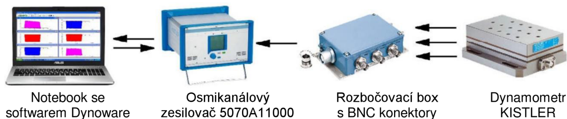
Obr. 4.10 Měřicí aparatura pro měření řezných sil [37].
