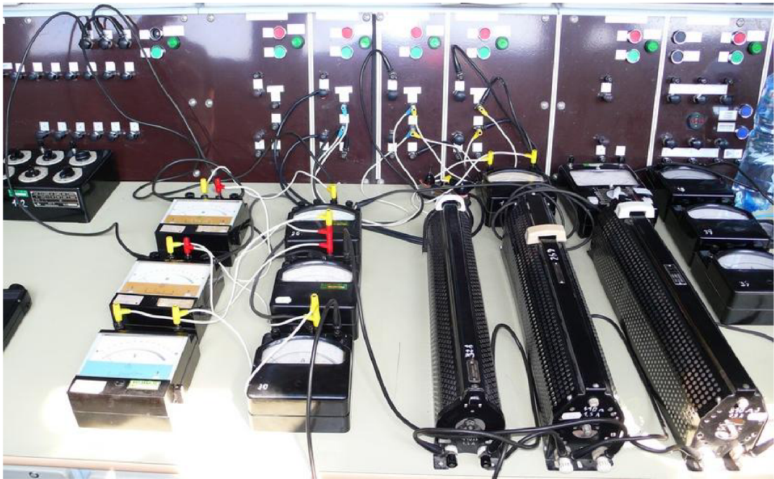
Obr. 5.2: Zapojení měřicích přístrojů a zátěže
