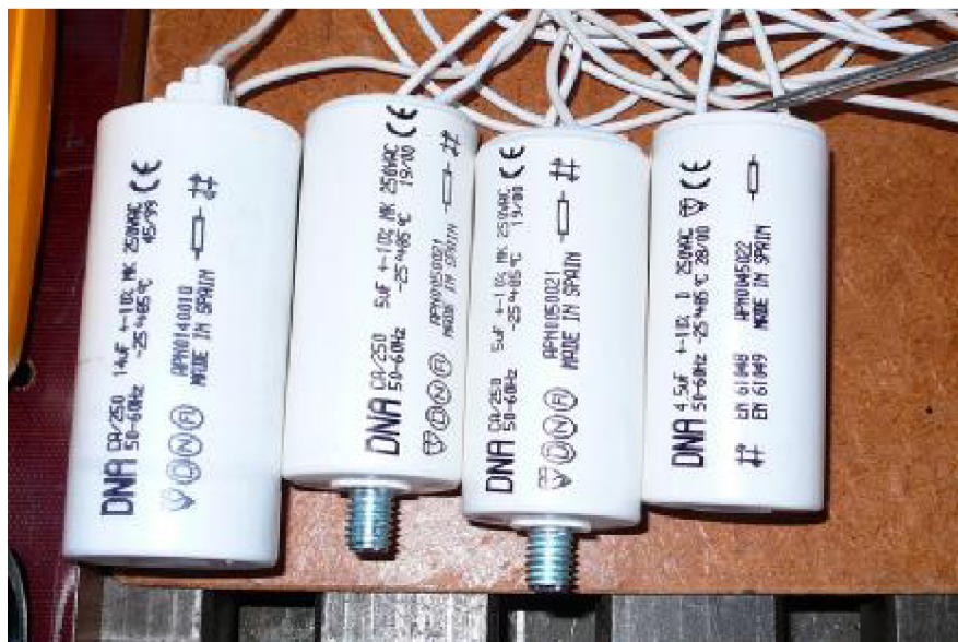
Obr. 5.4: Kondenzátory v zapojení pro C=28,5\mu\text{F}
