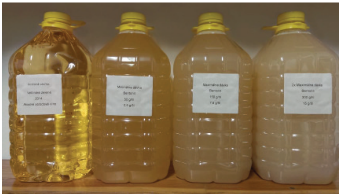
Obrázok 1: Variant s použitím rôznych dávok bentonitu a kontrolná vzorka.
