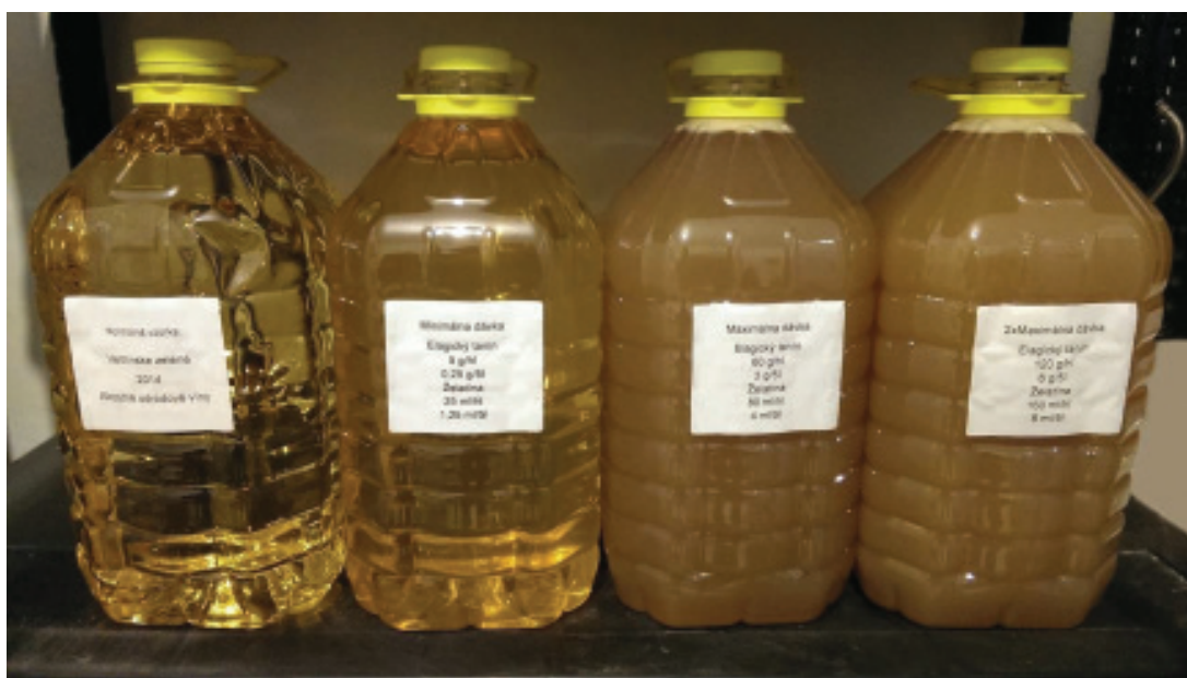
Obrázok 3: Variant s použitím rôznych dávok tanínu a želatíny a kontrolná vzorka.
