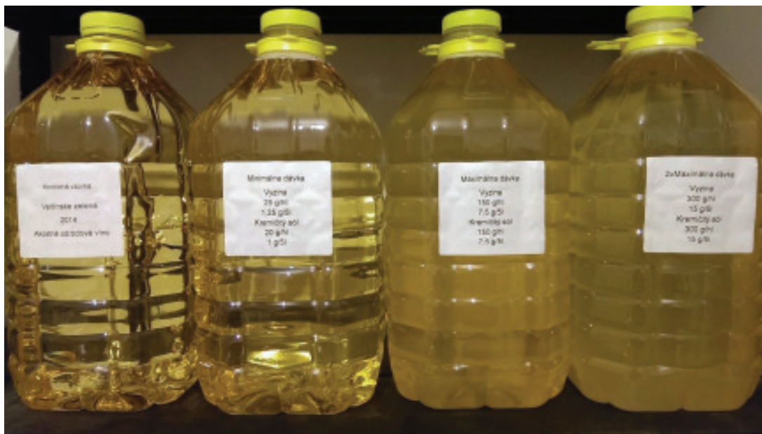
Obrázok 2: Variant s použitím rôznych dávok vyziny a kremičitého sólu a kontrolná vzorka.
