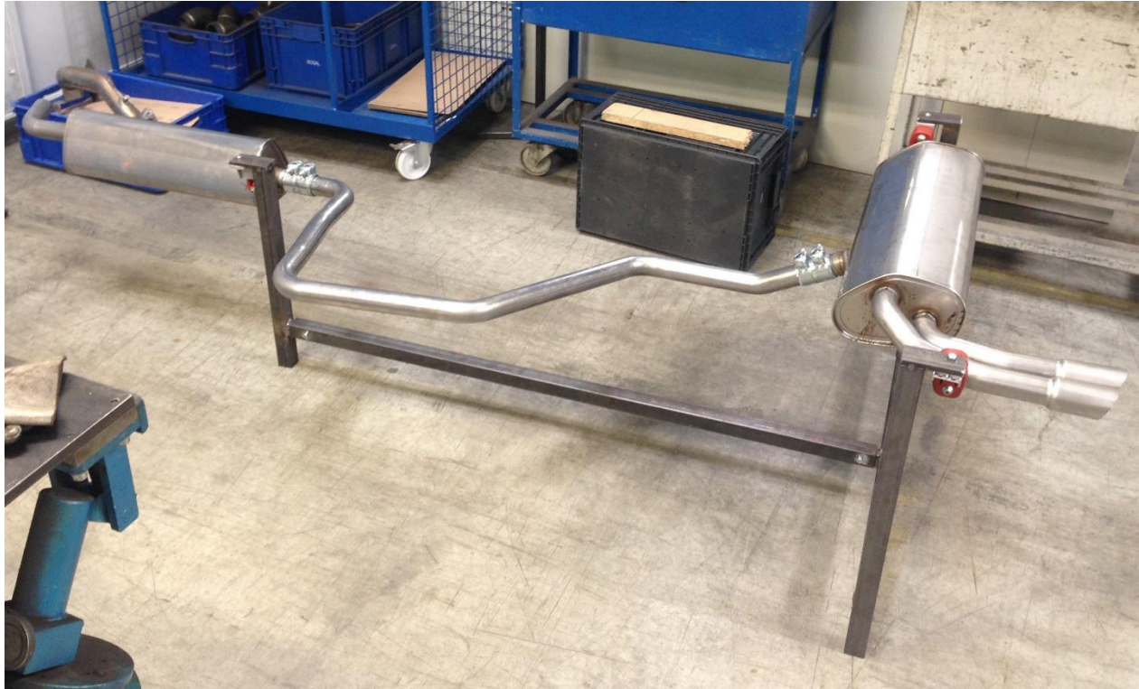
Obrázek 34: Sestavení zkušebního výfuku
