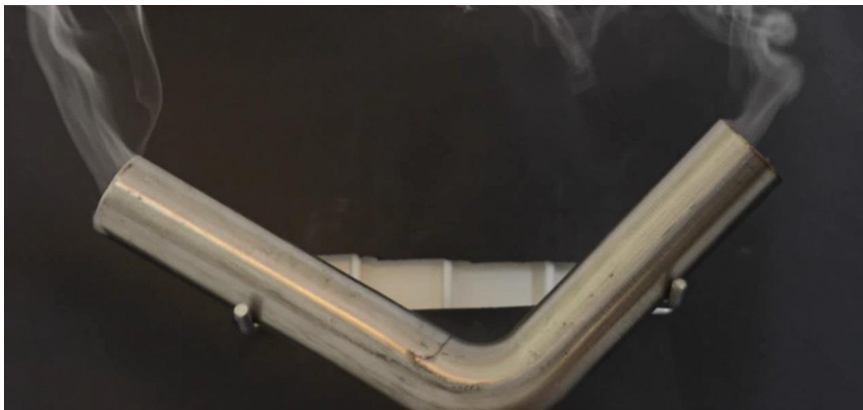
Obrázek 5: Moment nejvyšší kouřivosti při zahřívání maziva ALC
