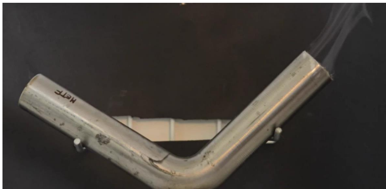
Obrázek 8: Moment nejvyšší kouřivosti při zahřívání maziva Metform O.F.gel
