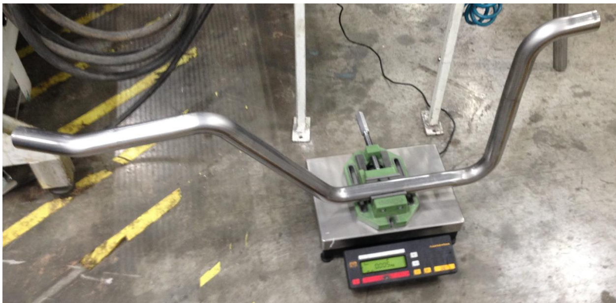
Obrázek 33: Měření hmotnosti maziva ohnuté trubky
