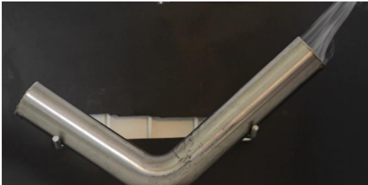
Obrázek 7: Moment nejvyšší kouřivosti při zahřívání maziva NIROL
