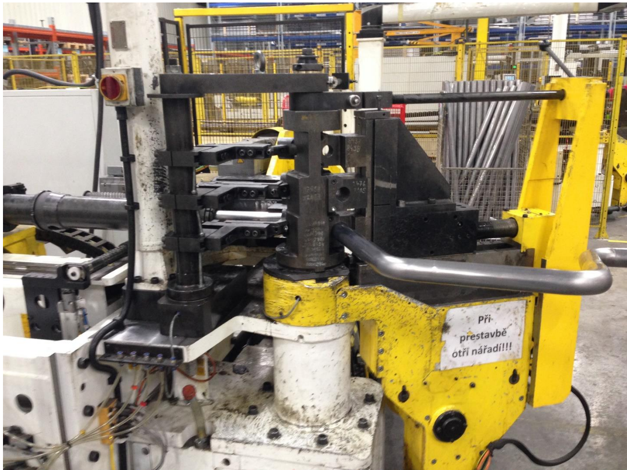
Obrázek 31: Ohýbačka Addison při ohýbání středové trubky
