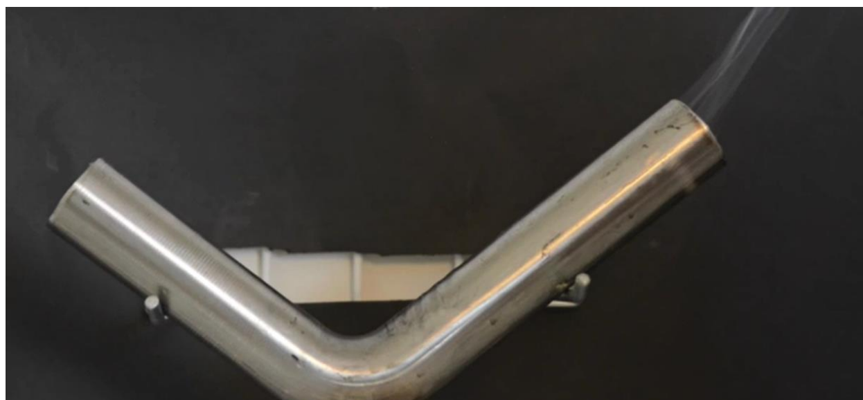
Obrázek 6: Moment nejvyšší kouřivosti při zahřívání maziva ALTO
