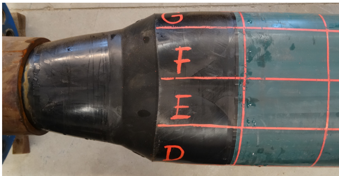
Obr. 14.69 Deformace potrubí - detail (vzorek A-D160-SDR11-BV-4)
