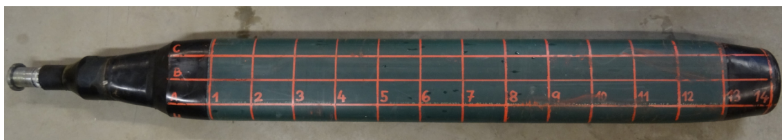
Obr. 14.31 Deformace potrubí (vzorek A-D160-SDR11-SV-3)
