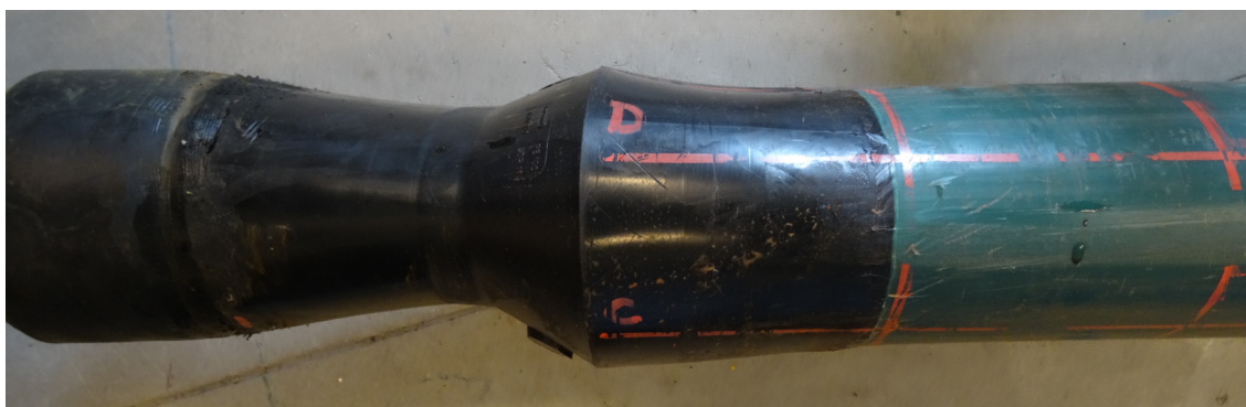
Obr. 14.21 Deformace potrubí - detail (vzorek A-D160-SDR11-SV-1)
