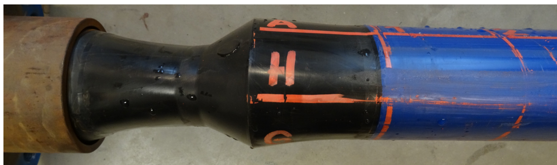
Obr. 14.63 Deformace potrubí - detail (vzorek A-D160-SDR11-BV-3)
