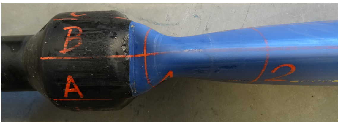
Obr. 14.110 Deformace potrubí - detail (vzorek C-D110-SDR17-BV-2)
