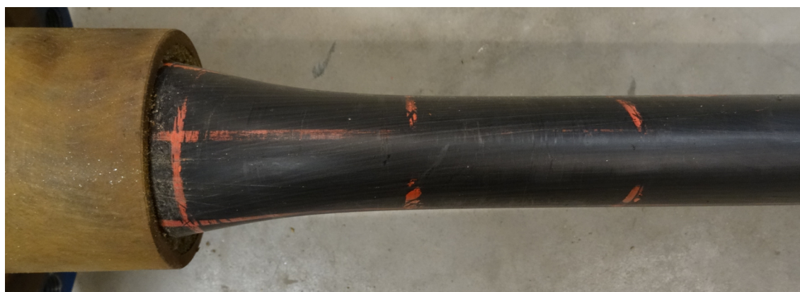
Obr. 14.99 Deformace potrubí - detail (vzorek C-D110-SDR11-SV-1)
