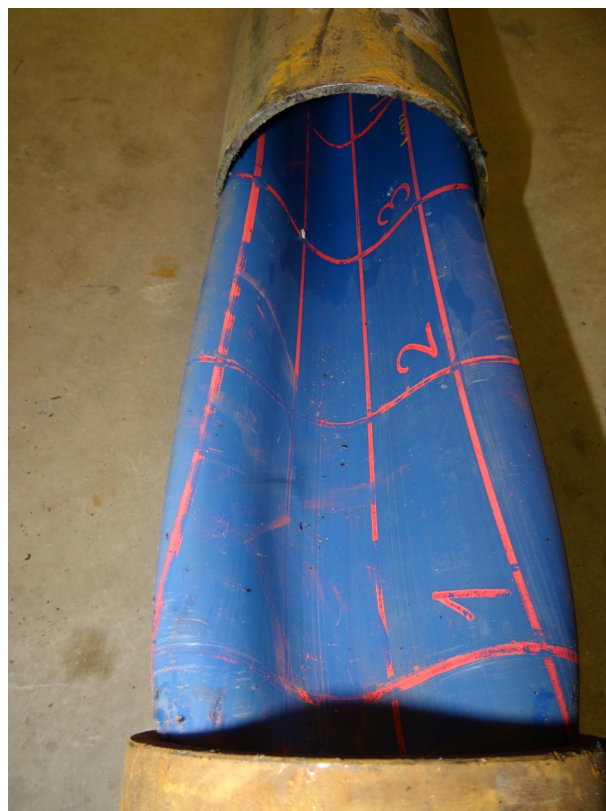
Obr. 14.93 Deformace potrubí (vzorek B-D110-SDR17-BV-2)
