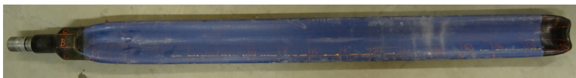
Obr. 14.91 Deformace potrubí (vzorek B-D110-SDR17-BV-2)
