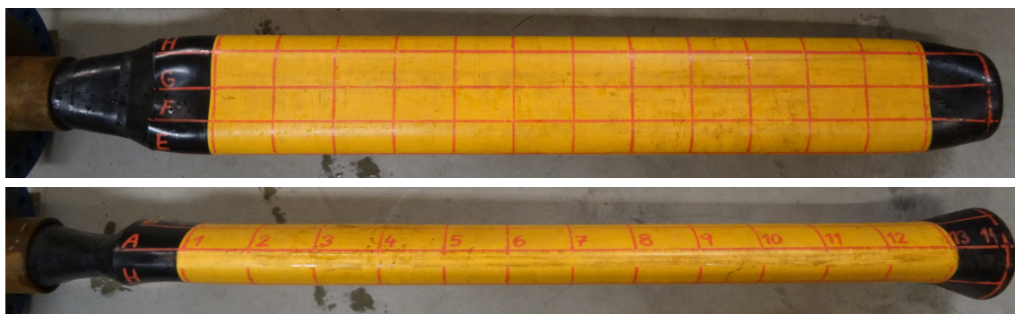
Obr. 14.55 Deformace potrubí (vzorek A-D160-SDR11-BV-2)
