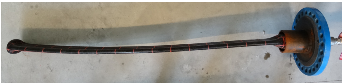
Obr. 14.4 Deformace potrubí ihned po zkoušce (vzorek A-D110-SDR17-SV-1)
