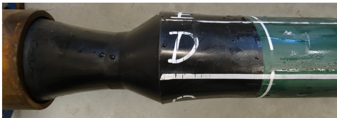
Obr. 14.45 Deformace potrubí - detail (vzorek A-D160-SDR11-SV-5)
