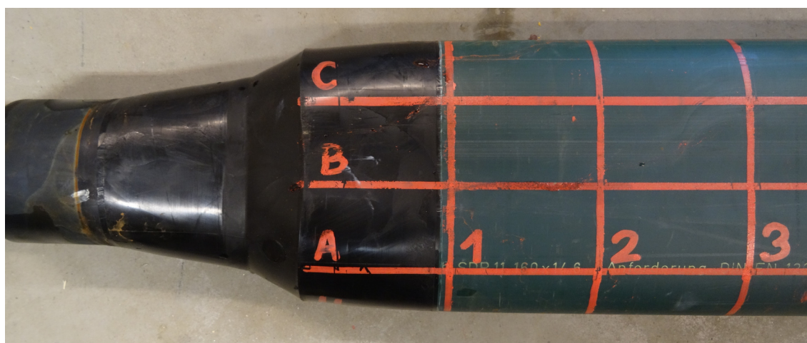
Obr. 14.33 Deformace potrubí - detail (vzorek A-D160-SDR11-SV-3)
