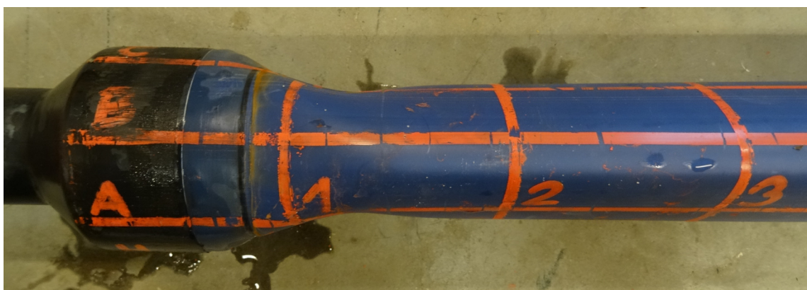
Obr. 14.11 Deformace potrubí - detail (vzorek A-D110-SDR17-BV-1)
