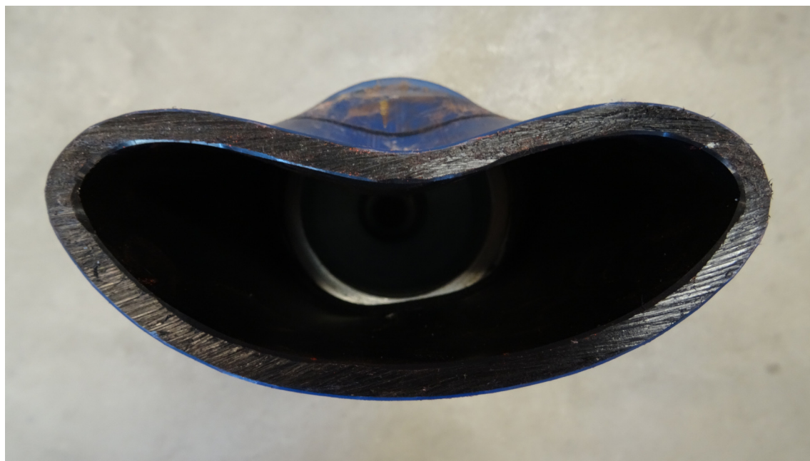
Obr. 14.87 Deformace potrubí - řez v měřícím bodu 2 (vzorek B-D110-SDR17-BV-1)
