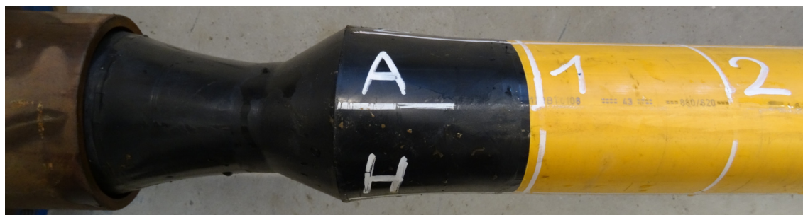
Obr. 14.39 Deformace potrubí - detail (vzorek A-D160-SDR11-SV-4)
