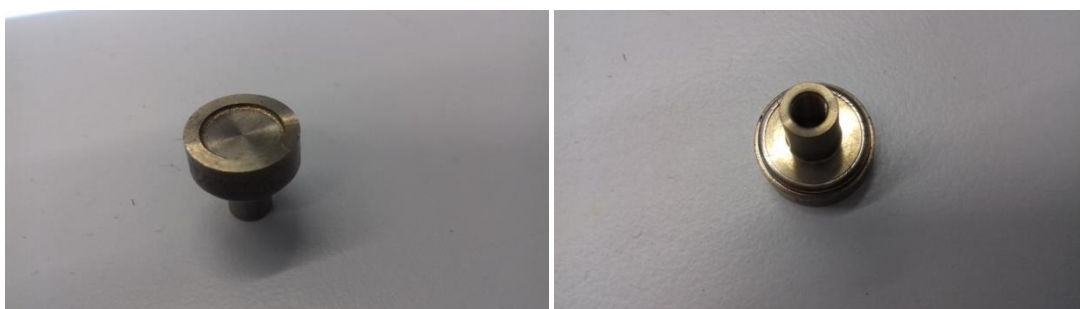
Obrázek 1: Zářič, zleva vrchní strana a zprava spodní strana zářiče, zašroubovává se do MS.
