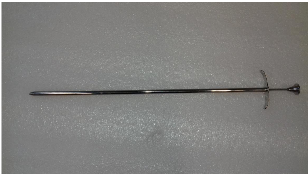
Obrázek 16: Pinzeta (meč) k zachycení a manipulaci vzorku nebo zářiče.
