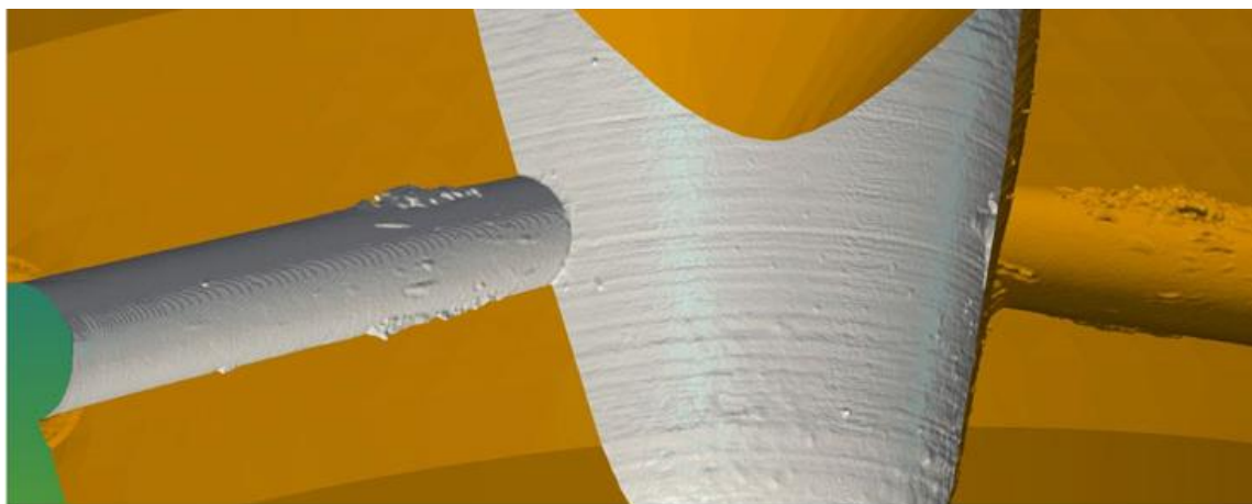
Obr. 3 CT-sken vstrekovacej trysky poškodennej kavitáciou; upravené podľa [23]
