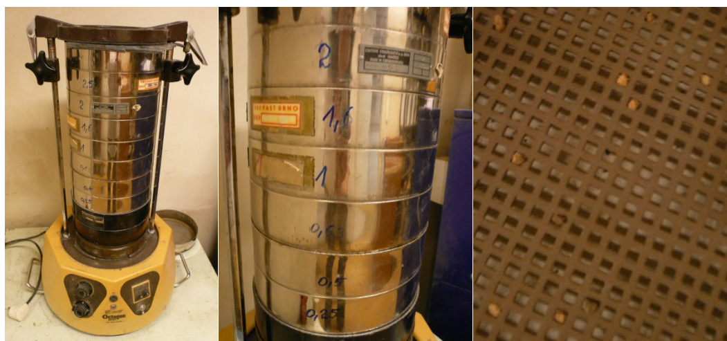
b) prosévací přístroj, sada normových sít se čtvercovými oky pro síťový rozběr
