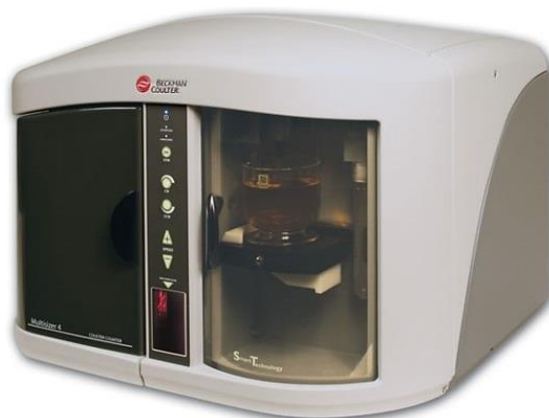
Obrázek 12 – Multisizer™ 4e COULTER® Counter – čítač částic velikosti v rozsahu 0,2 \mu\text{m} až 1600 \mu\text{m} firmy BeckmanCoulter využívající Coulterovu impedanční metodu [29]
