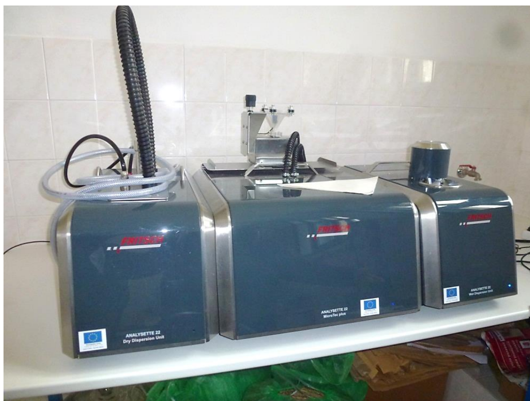
Obrázek 10 – ANALYSETTE 22 NanoTec – laserový měřič velikosti částic v rozsahu 0,01 \mu\text{m} až 2100 \mu\text{m} firmy Fritsch, vlastník zařízení Slovenská poľnohospodárska univerzita v Nitre (foto Pařílková)
