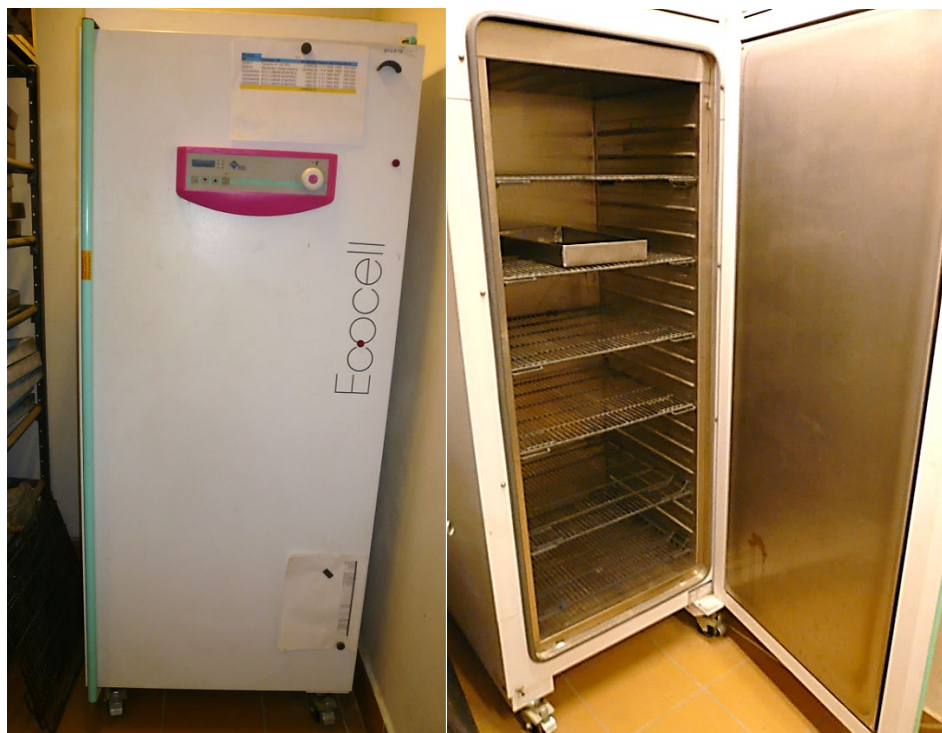
a) sušárna teplotní skříň ECOCELL ECO 707
