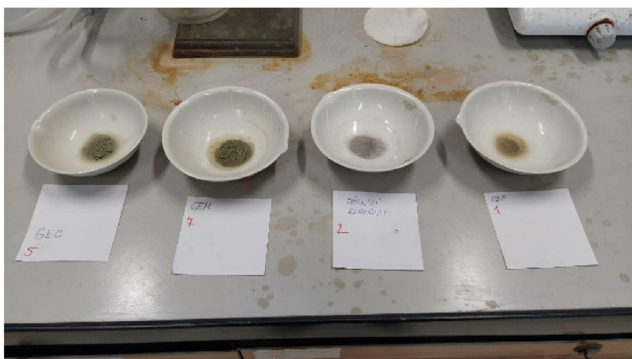
Obrázek 21 – Vysušení zrn větších než 0,063 mm
