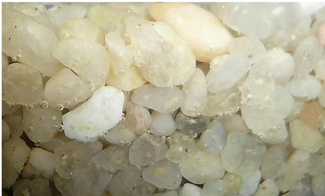
Obrázek 25 – Vzduchové bubliny při měření vzorku zeminy zatíženého destilovanou vodou
