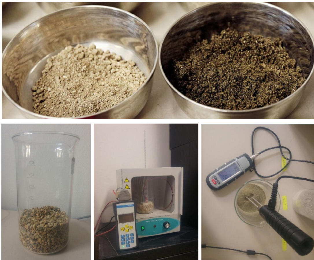
Obrázek 24 – Měření elektrické impedance zemin
