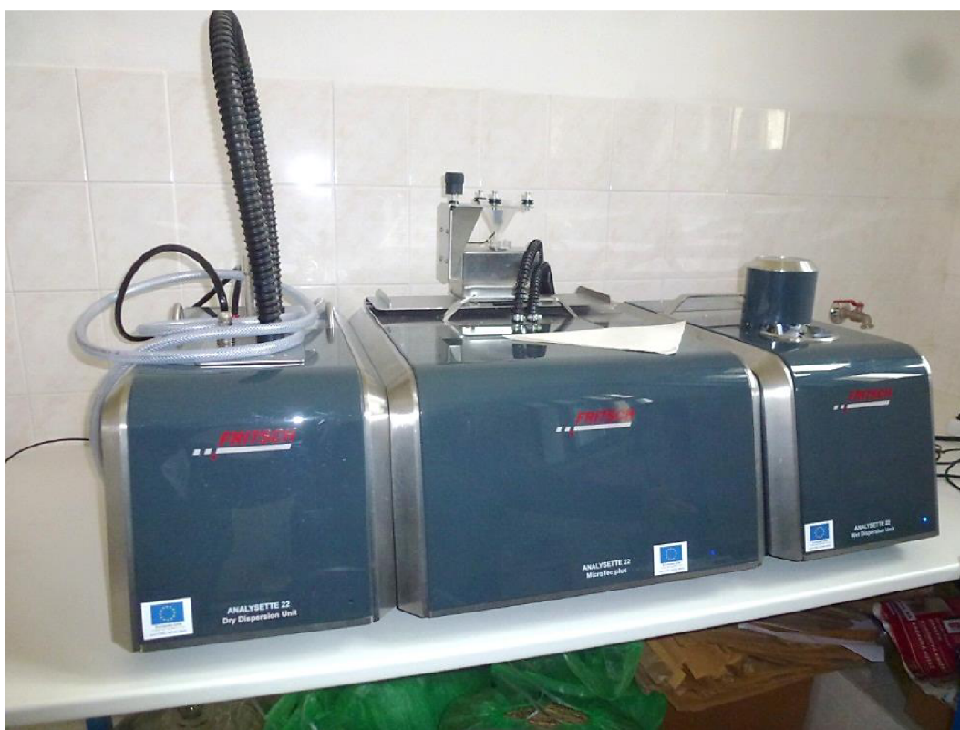
Obrázek 10 – ANALYSETTE 22 NanoTec – laserový měřič velikosti částic v rozsahu 0,01 \mu\text{m} až 2100 \mu\text{m} firmy Fritsch, vlastník zařízení Slovenská poľnohospodárska univerzita v Nitre (foto Pařílková)
