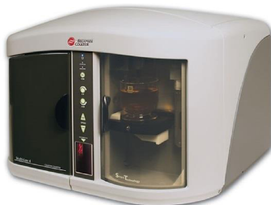
Obrázek 12 – Multisizer™ 4e COULTER® Counter – čítač částic velikosti v rozsahu 0,2 \mu\text{m} až 1600 \mu\text{m} firmy BeckmanCoulter využívající Coulterovu impedanční metodu [29]
