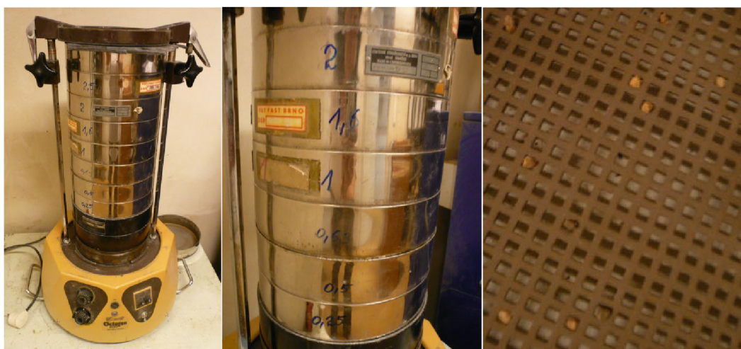
b) prosévací přístroj, sada normových sít se čtvercovými oky pro síťový rozbor
