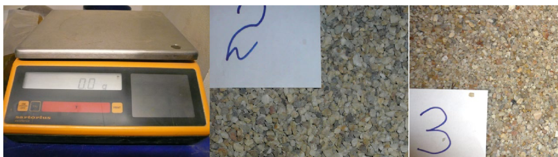
c) váhy Sartorius pro vážení zbytku vzorku zeminy na sítě
