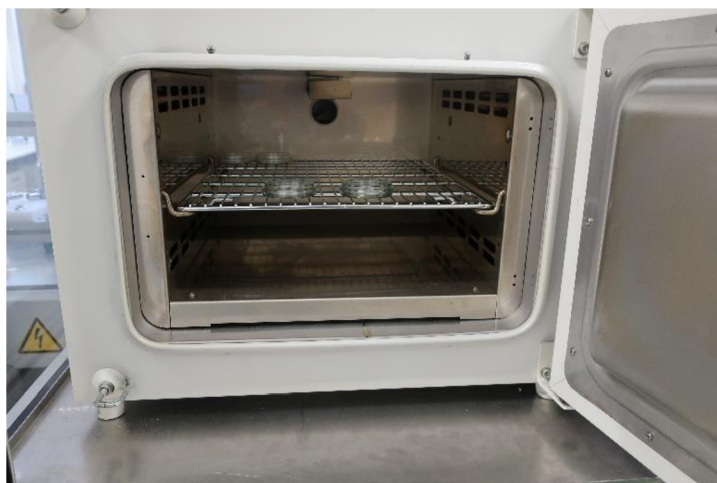
Obr. 26) Pec pro vysoušení filtru [foto autor]
