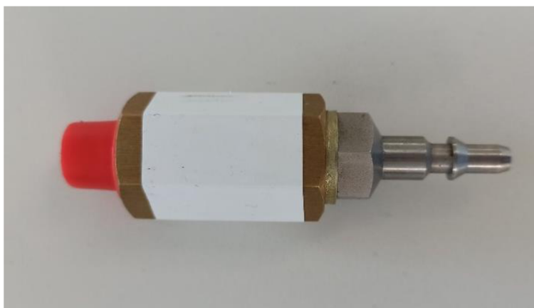
Obr. 17) Kalibrační měrka pro měření úniku tekutiny [foto autor]
