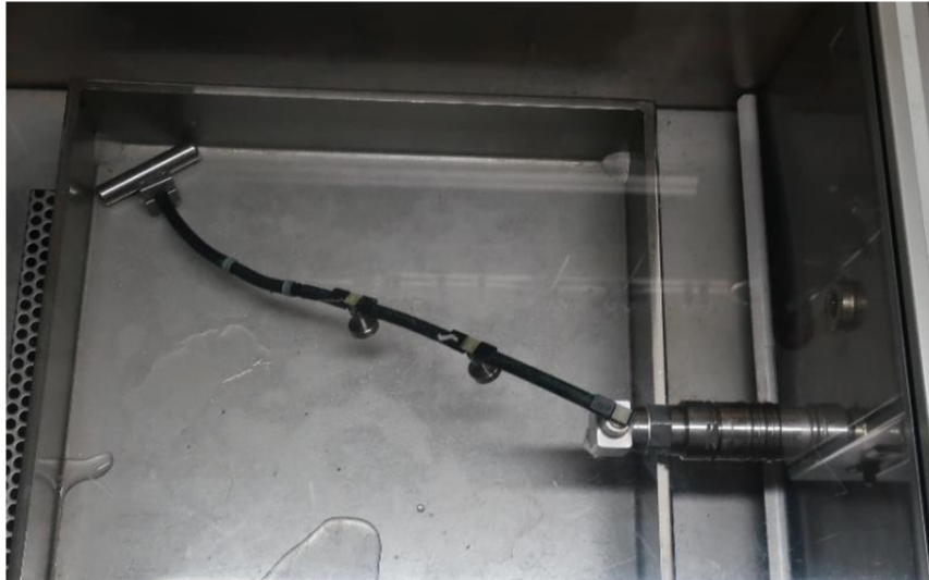
Obr. 22) Burst Test [foto autor]
