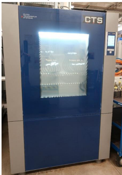
Obr. 29) Teplotní komora [foto autor]
