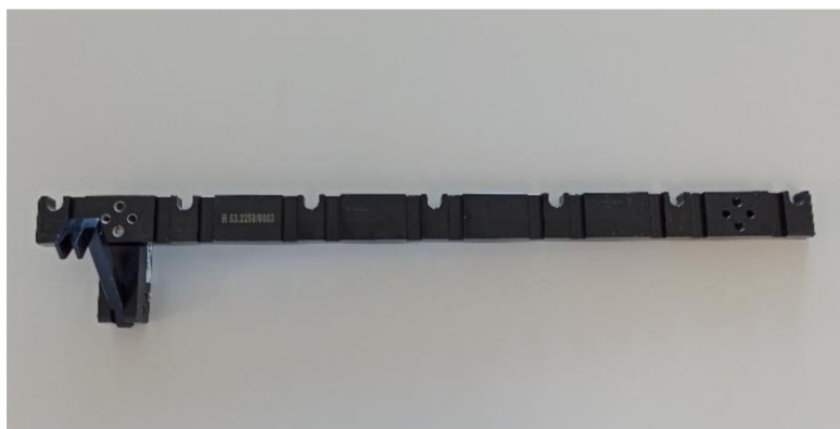
Obr. 16) Kalibrační měrka pro měření délkových rozměrů [foto autor]
