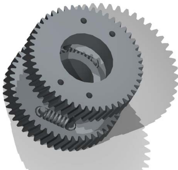
obr. 7.5. detail pastorku s tažnými pružinami
