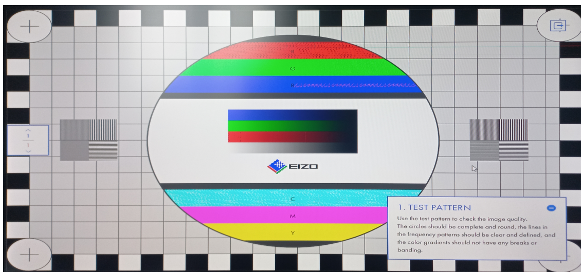
Obr. 6.9: Ukázka chybně přeneseného HDMI signálu, rozlišení 1280x720
