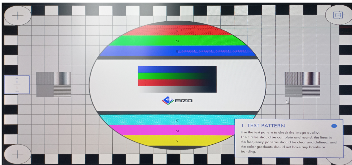
Obr. 6.9: Ukázka chybně přeneseného HDMI signálu, rozlišení 1280x720
