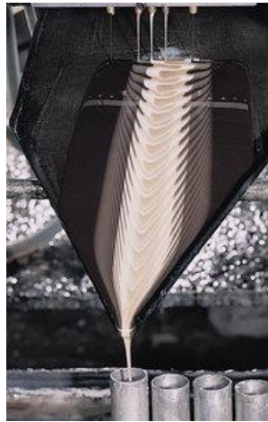
Obrázek 4. - Odlévání hmoty do hliníkových tyčí
