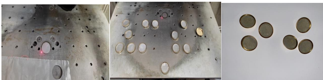
Obrázek 19. - Výroba nového produktu - přelití materiálu
