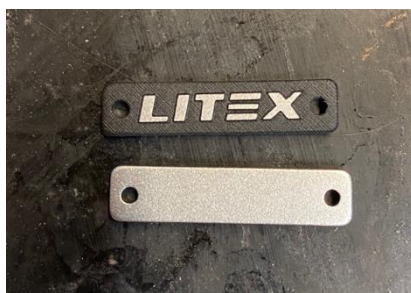
Obrázek 6. - Vzor vytvořen za pomoci laseru
