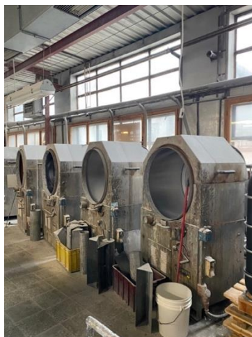
Obrázek 3. - Technologie lití hmoty do válce
