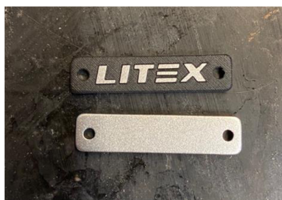
Obrázek 6. - Vzor vytvořen za pomoci laseru
