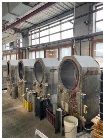
Obrázek 3. - Technologie lití hmoty do válce
