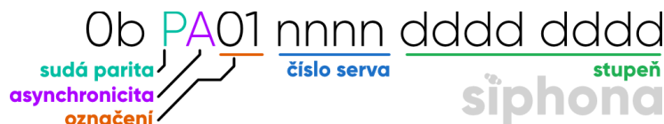
Obr. 13 struktura formátu přímého ovládání Siphony
