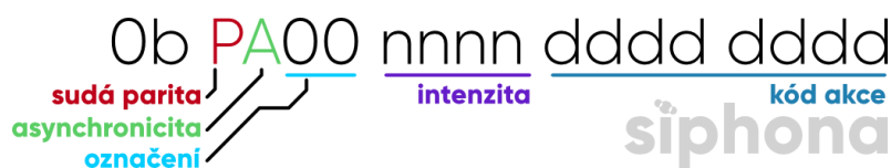
Obr. 14 struktura formátu předdefinovaných akcí Siphony
