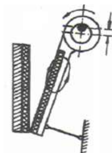
Obrázek č. 13: Princip jednovzpěrného drtiče
