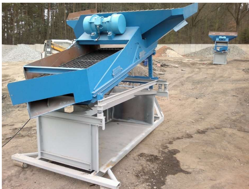
Obrázek č. 18: Vibrační třídíč
