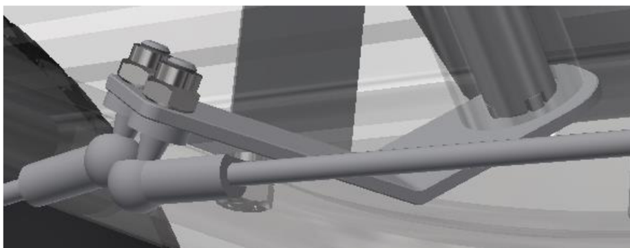
Obr. 4.19 Připojení tyče řízení
