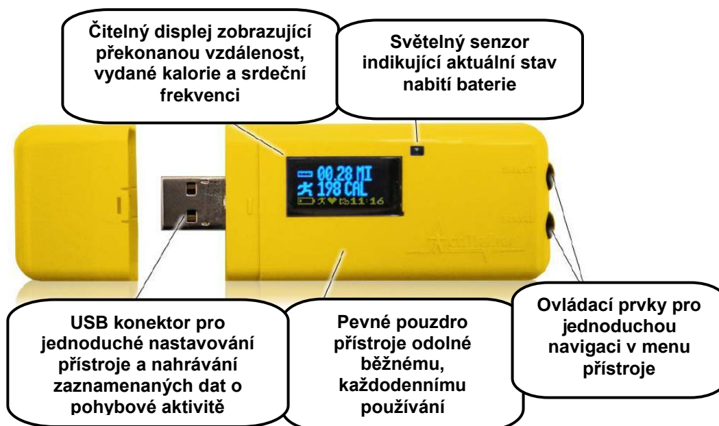
Obrázek 4. Multifunkční monitorovací přístroj ActiTrainer s popisem ovládacích prvků dle Sigmunda a Sigmundové (2011, 36)
