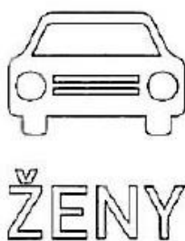
Obrázek 7 - Označení vyhrazených parkovacích stání pro ženy (zdroj: ČSN 73 6056)
