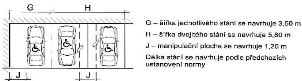
Obrázek 5- Prostorové uspořádání parkovacích stání s kolmým řazením pro vozidla přepravující osoby těžce pohybově postižené (Zdroj: ČSN 73 6056)
