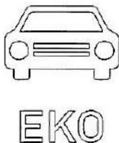
Obrázek 6 - Označení vyhrazených parkovacích stání pro ekovozidla (zdroj: ČSN 73 6056)
