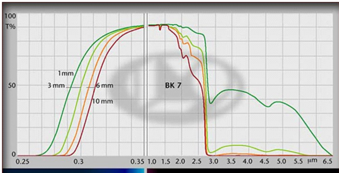
Obr. 7: spektrální propustnost skla BaK7 [10]
