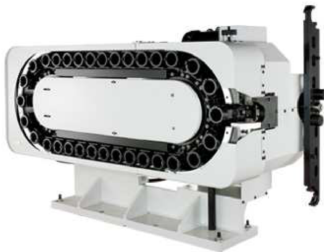
Obr. 6: AVN s horizontálním řetězovým zásobníkem s výklopným lůžkem čínské firmy BEI JYU
