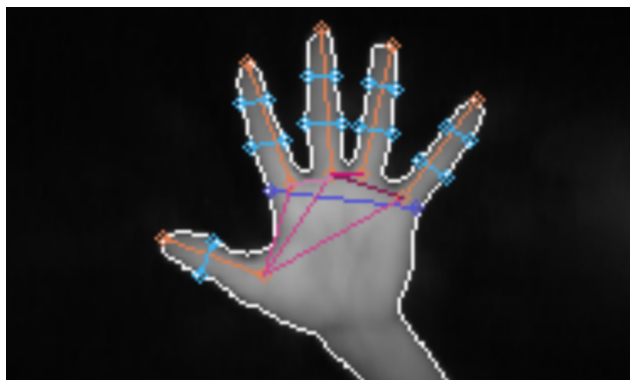
Obr. 6.1: Vizualizácia charakteristík, ktoré sú extrahované z dát zaznamenaných ovládačom Leap Motion – farebne sú znázornené jednotlivé charakteristiky: oranžovou farbou dĺžky prstov, svetlomodrou farbou šírky prstov, fialovou šírka dlane, odtieňmi ružovej vzdialenosti medzi stredmi začiatkov prstov
