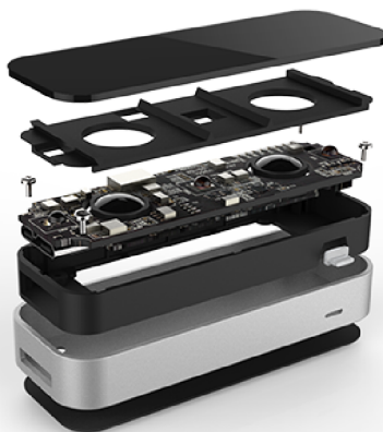
Obr. 4.1: Vizualizácia hlavných hardwarových súčasti senzora Leap Motion [6]
