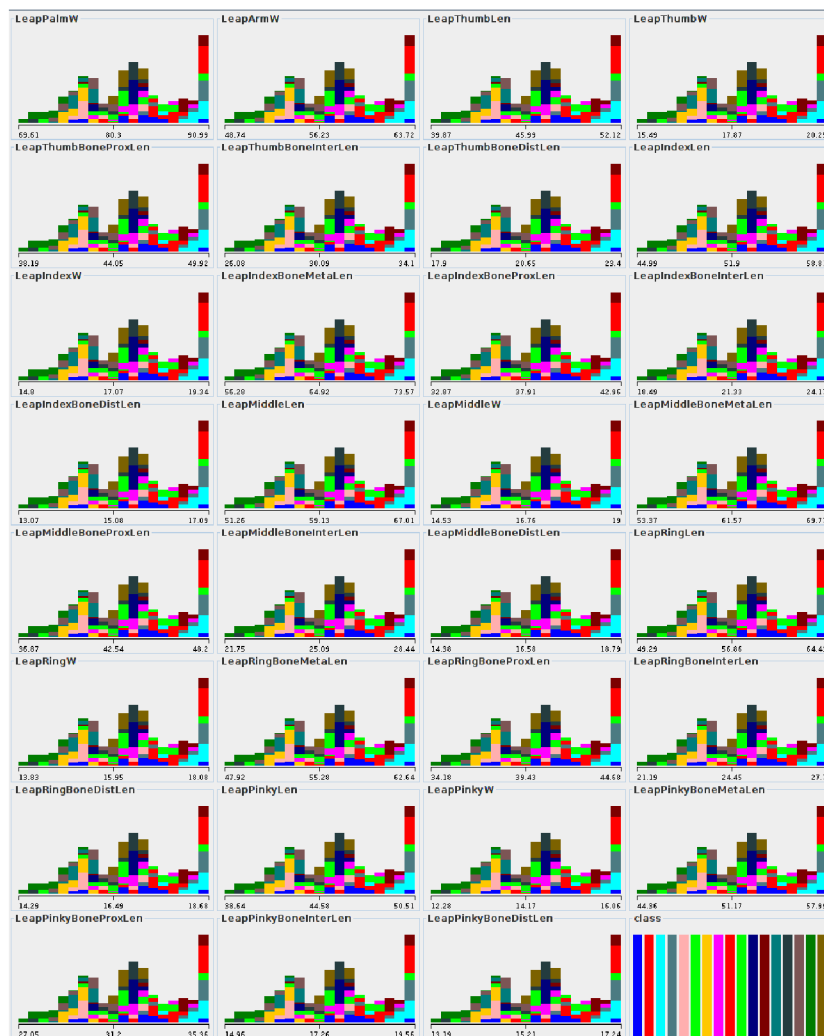
Obr. B.1: Histogramy poukazujúce na úplnú koreláciu dát získaných z aplikačného rozhrania zariadenia Leap Motion, vizualizácia pomocou nástroja WEKA
