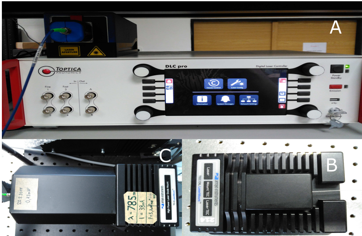
Obrázek 5.3: Testované zdroje záření, Laser firmy Topica (A), Butterfly Diode (B), prototypové diody (C)
