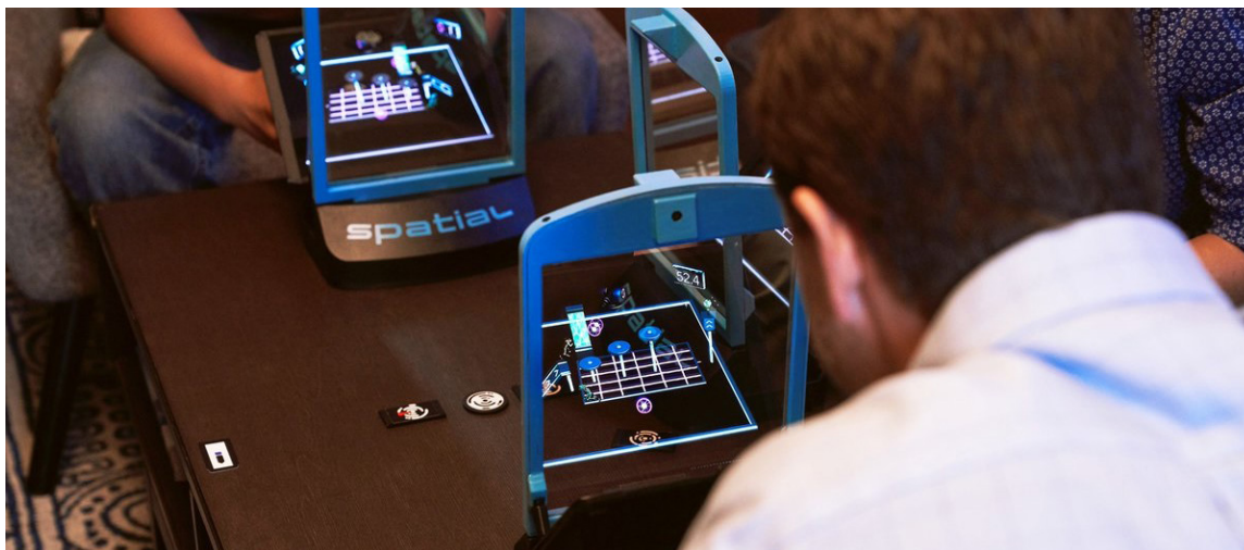
Obr. 2.5: Zariadenie Spatial MRX predstavujúce typ Spatial Optical See-Through displeja. 5
