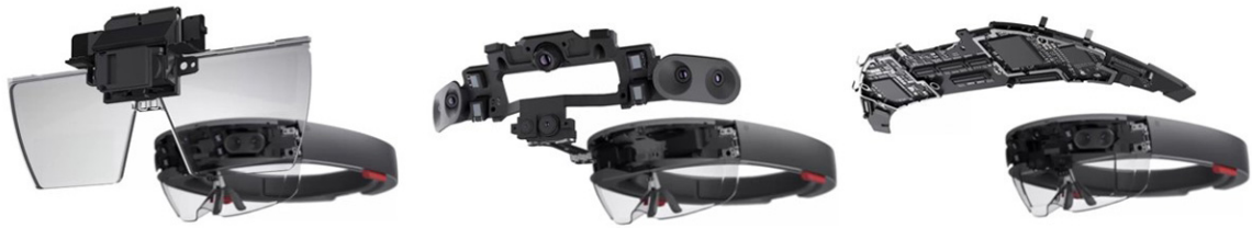
Obr. 3.2: Časti HoloLens headsetu: Optika (vľavo), senzory (stred), základná doska (vpravo). 3
