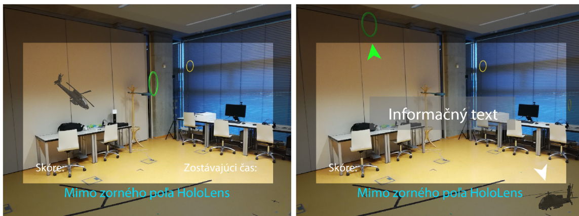
Obr. 4.1: Návrh rozhrania aplikácie. Vľavo : Hologramy helikoptéry a checkpointov – zelený je práve aktívny. V ľavom dolnom rohu sa nachádza ukazovateľ skóre, v pravom zostávajúci čas. Vpravo : Návrh navigácie, ktorá sa zobrazí v prípade, že sú objekty „offscreen“. Šípky smerujúce k sledovanému objektu sa zobrazujú pozdĺž hrán displeja. Sledovaný je len aktívny checkpoint a helikoptéra. Informačný text sa zobrazí len ak dôjde k zničeniu helikoptéry alebo odpojeniu telefónu.
