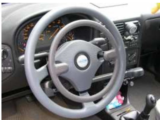
Obr. 3: Ruční ovládání brzdy a mechanický plyn - kruh
