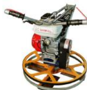
Obrázek 5.31 Hladička dvourotorová, hladička krajová
