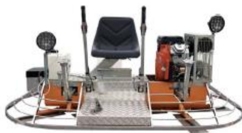
Obrázek 5.31 Hladička dvourotorová, hladička krajová
