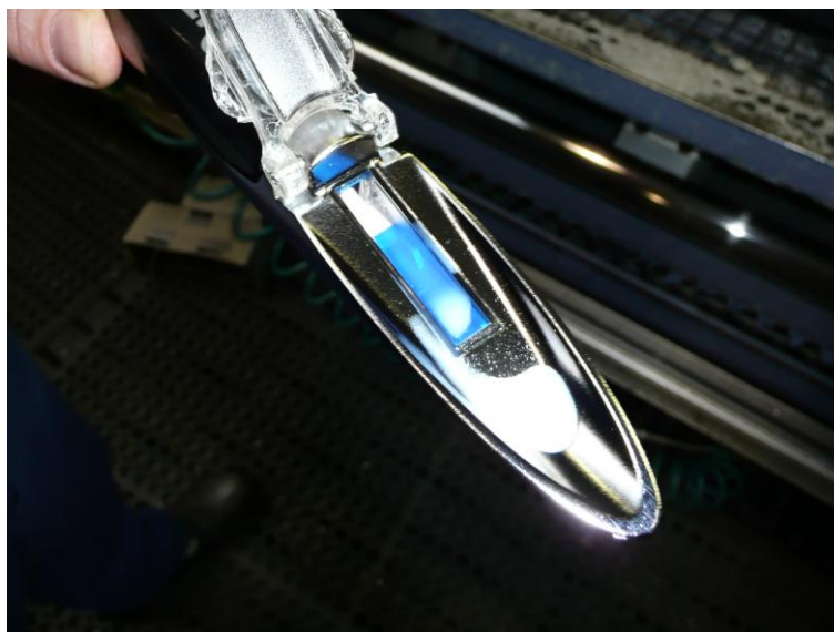
Obr. 2.4 Měření koncentrace emulze pomocí refraktometru.
