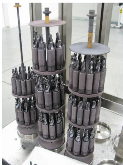
Obr. 3.7 Speciální košíky pro umístění nástrojů v povlakovací komoře.
