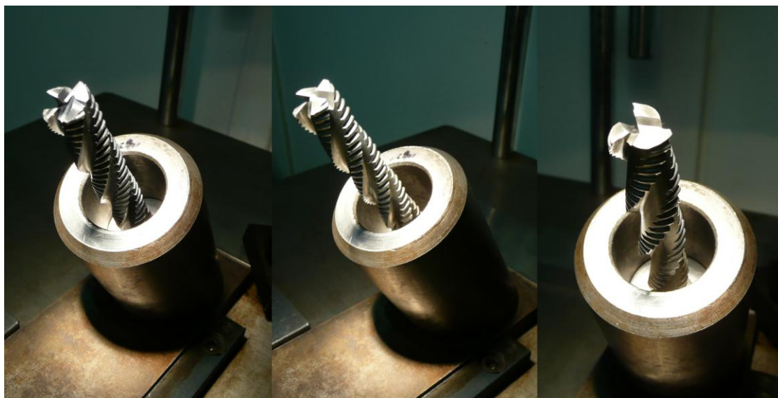
Obr. 4.3 Měření opotřebení na hřbetě - VB.
