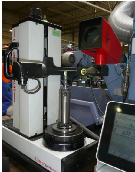
Obr. 2.9 Nový nástroj se musí v upínači ustavit vč. nastavení korekcí.
