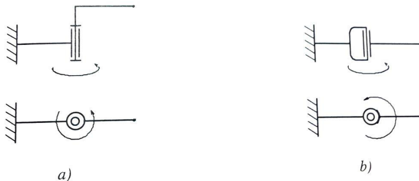
Obr. 12 Rotačné KD s ramenom "r" (kĺby) s náryse a pôdoryse a)bez obmedzenia uhlu otáčania b) s obmedzením otáčania [3]
