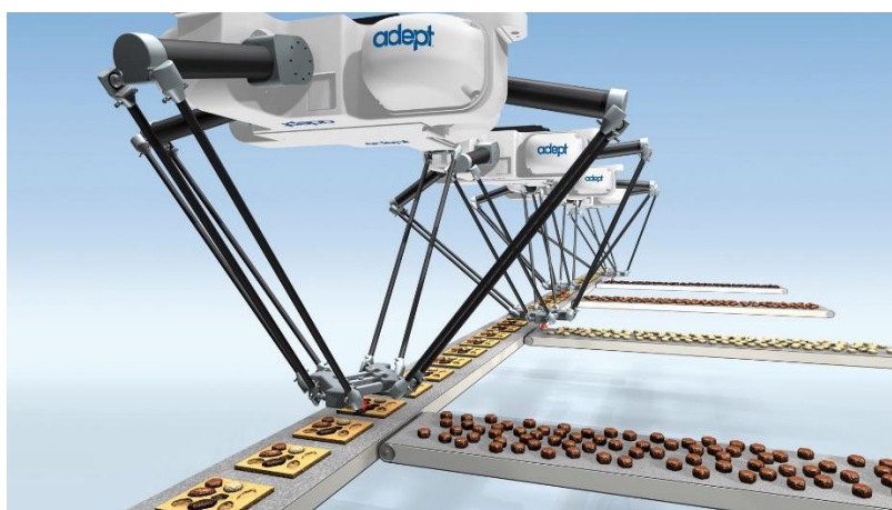
Obr. 53 Adept Quattro s650H pri práci s bonbónmi [38]
