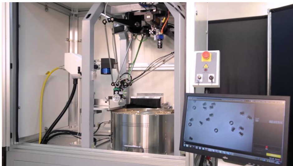
Obr. 57 SIAK D3 - 500 pri práci so skrutkami [40]
