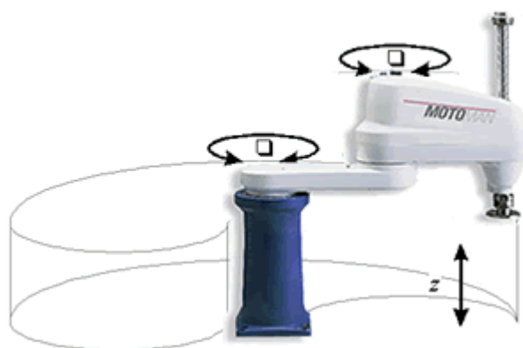
Obr. 23 SCARA robot s jeho pracovným priestorom [16]
