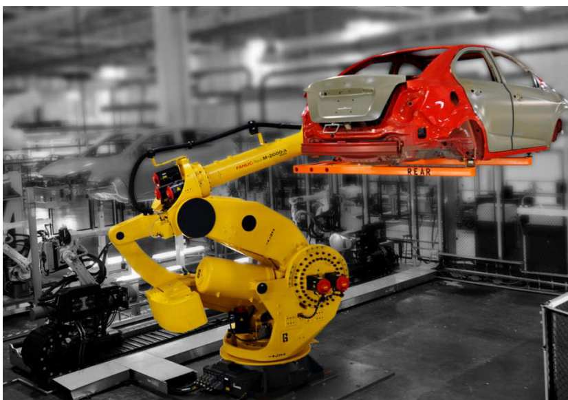
Obr. 49 Priemyselný robot Fanuc M-2000iA/1200 pri manipulácii s karosériou [33]
