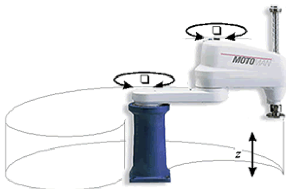
Obr. 23 SCARA robot s jeho pracovným priestorom [16]
