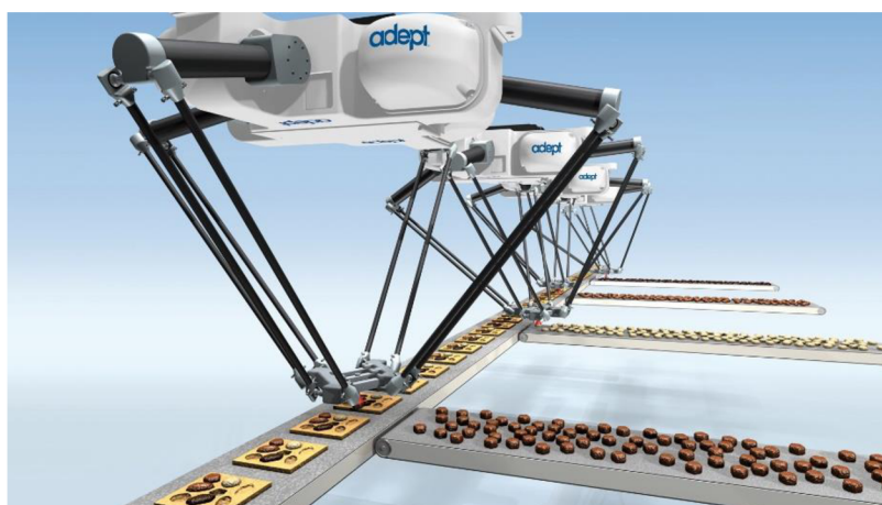
Obr. 53 Adept Quattro s650H pri práci s bonbónmi [38]
