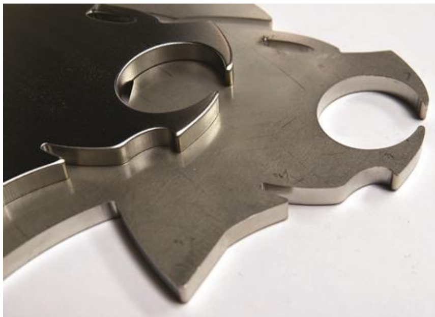
Obr. 9) Rozdíl mezi nepracovaným a odjehleným dílem [6]
