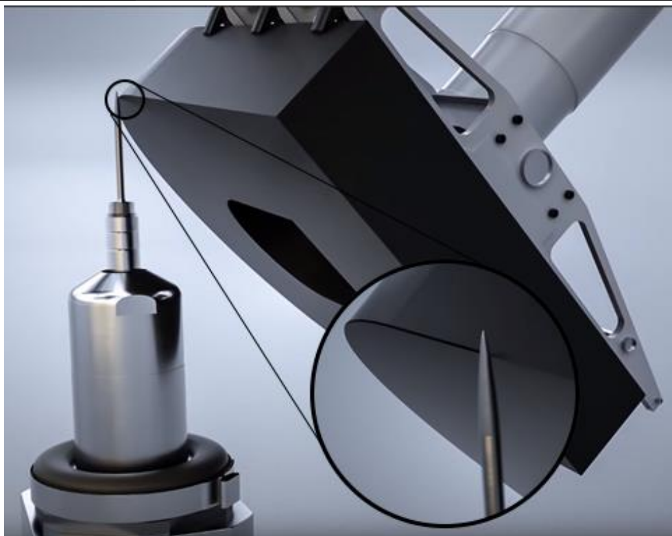
Obr. 16) Příklad aplikace odjehlování kolem externího nástroje [25]
