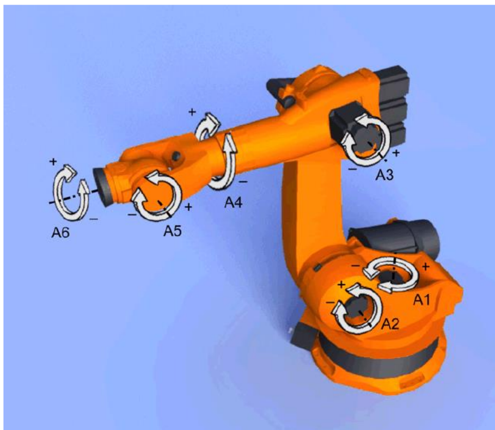
Obr. 23) Osový souřadný systém robotu Kuka [36]
