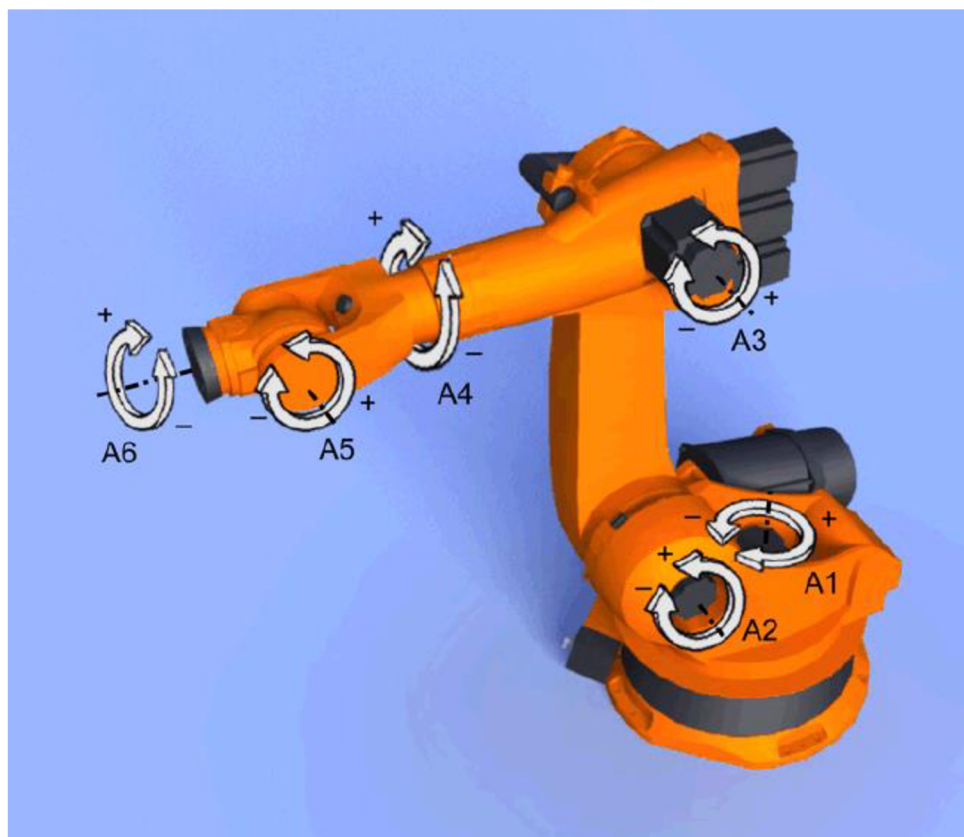
Obr. 23) Osový souřadný systém robotu Kuka [36]
