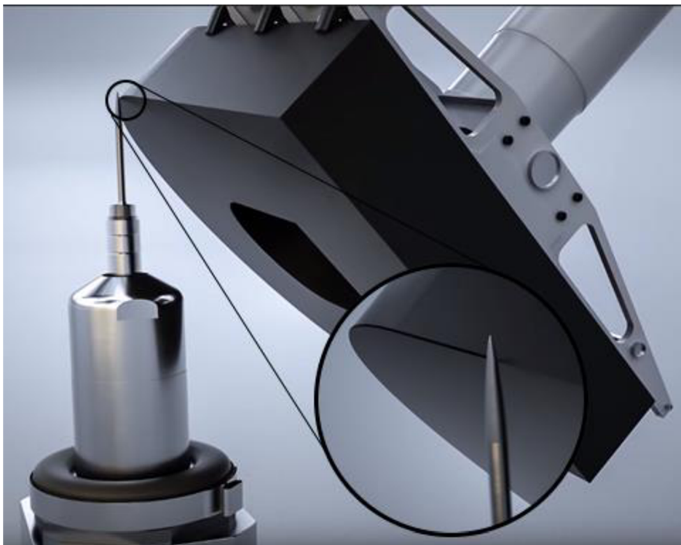
Obr. 16) Příklad aplikace odjehlování kolem externího nástroje [25]
