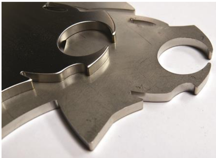
Obr. 9) Rozdíl mezi nepracovaným a odjehleným dílem [6]
