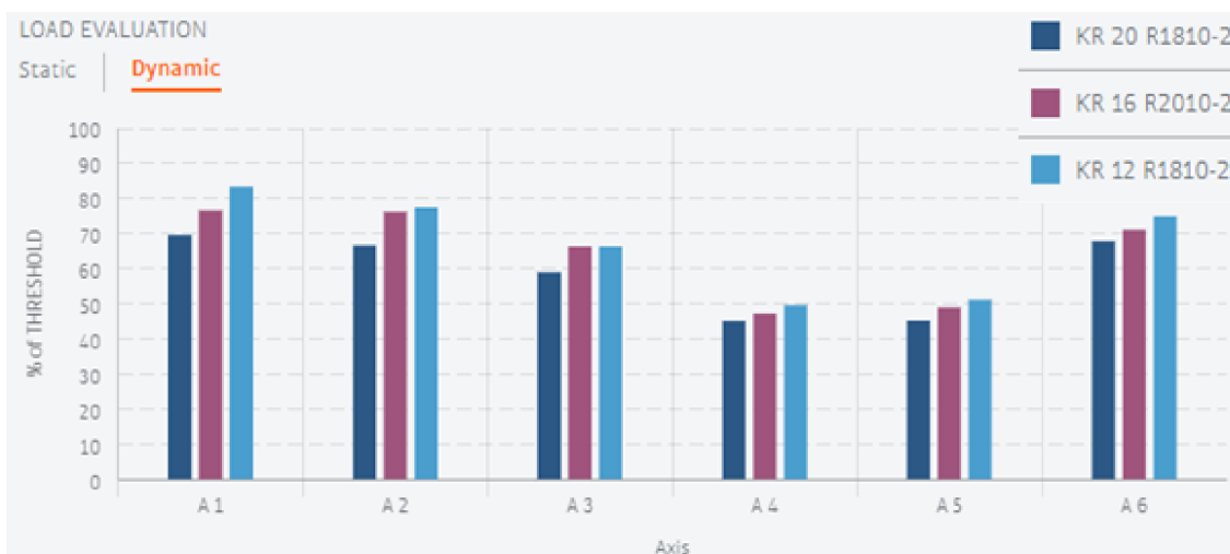
Obr. 39) Zatížení vybraných robotů a) statické, b) dynamické [41]
