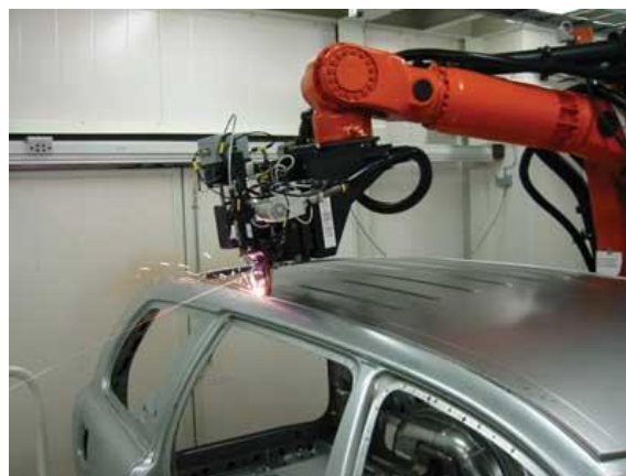
Obr. 2 Laserové svařování střechy[31]
