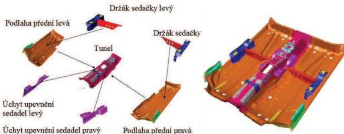
Obr. 4 Kompletování podlahy bodovým svařováním [7]
