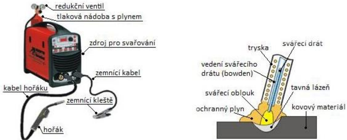
Obr. 1 Princip metody MIG, MAG [30]
