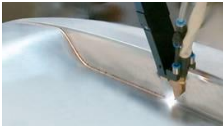
Obr. 5 Laserové pájení zadních dveří [13]
