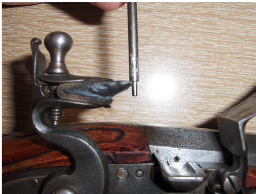
Obrázek 11: Nástroj na doostřování, a vyklepávání nové vodící hrany, přejato z https://www.muzzleloadingforum.com/threads/correct-use-of-a-knapping-hammer.108833/
