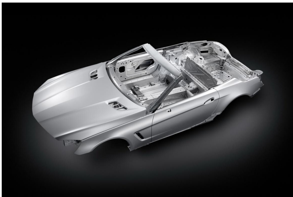
Obr. 12 Celohliníková karoserie Mercedes - Benz SL (autorevue.cz)
