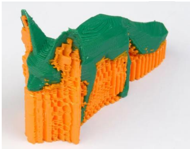
Obrázek 5: Podpěry při 3D tisku
