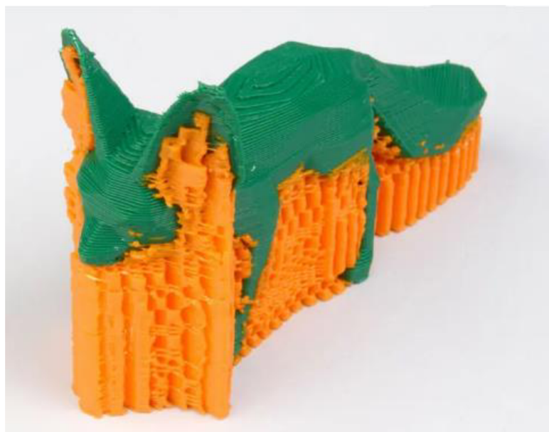
Obrázek 5: Podpěry při 3D tisku
