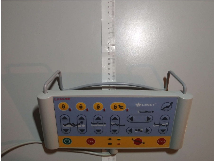
Obr. 7.4: Měření posunu ovladače o 10 cm na desce stolu
