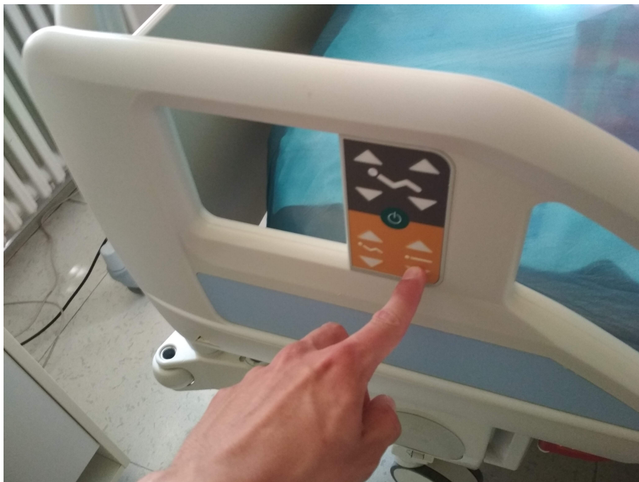
Obr. 5.3: Stisk funkčního tlačítka pro záznam projevů polohování postele
