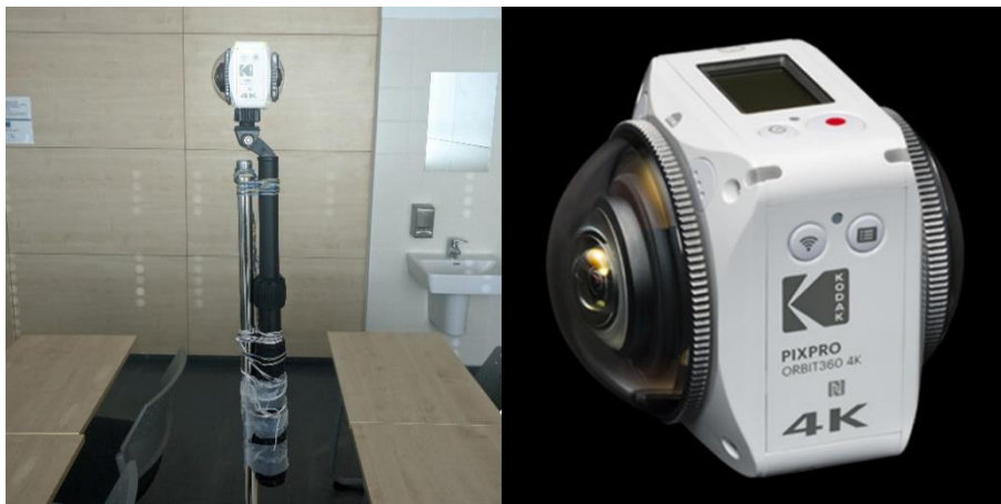
Obr. 35 KODAK PIXPRO ORBIT360 4K VR kamera a její umístění na stojanu Zdroj: Autor | Převzato z: [46]
