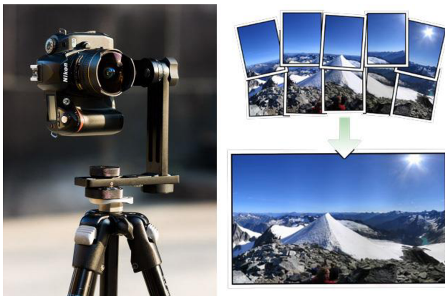
Obr. 8 Ukázka techniky segmentů Převzato z: [14],[15]
