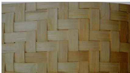
Obrázek 15 Keprová vazba 2/2, převzato a upraveno z [24, s. 44]
