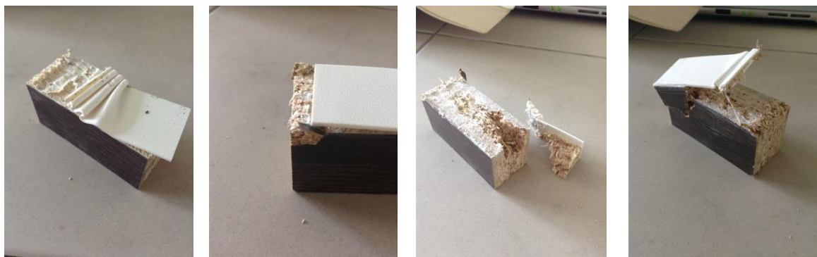
Obr. 49; 50; 51; 52 príklady extrémnych poškodení na DTD a ABS
